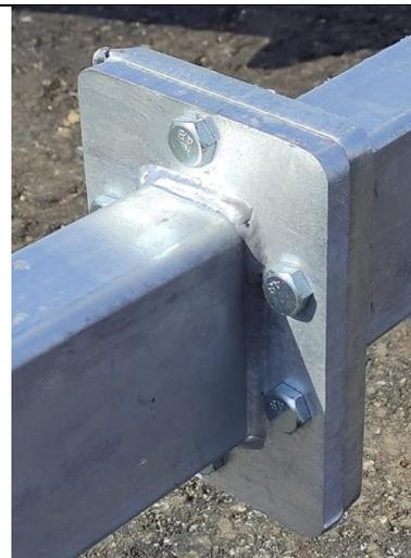
2) Соединить треноги **11** с элементами основания **10**, продев верхнюю трубу треноги внутрь трубы элемента основания и соединив их при помощи болтов M12x220, шайб и гаек M12. На каждую треногу предусмотрено по 1 болту, 2 шайбам (внешний Ø54мм, внутренний Ø12 мм) и 1 гайке.
